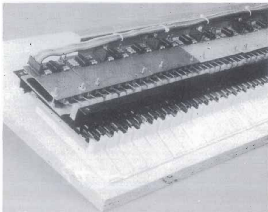
Fotografía 1. En esta fotografía se muestra cómo están montadas y cableadas las unidades de supresión de rebotes, de entrada, de desplazamiento de sintonía y la tarjeta de bus.
