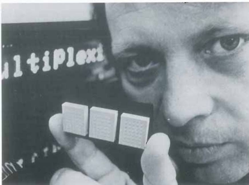
Estas nuevas matrices indicadoras (de 5 \times 7 puntos) de Siemens, con lógica de control completa, tienen una inteligencia suficiente para generar 96 números y caracteres con el sencillo código ASCII. En nuestra foto se ven tres muestras para luz naranja, roja y verde. Al fondo un texto luminoso escrito con indicadores individuales, colocados formando una hilera ininterrumpida.
