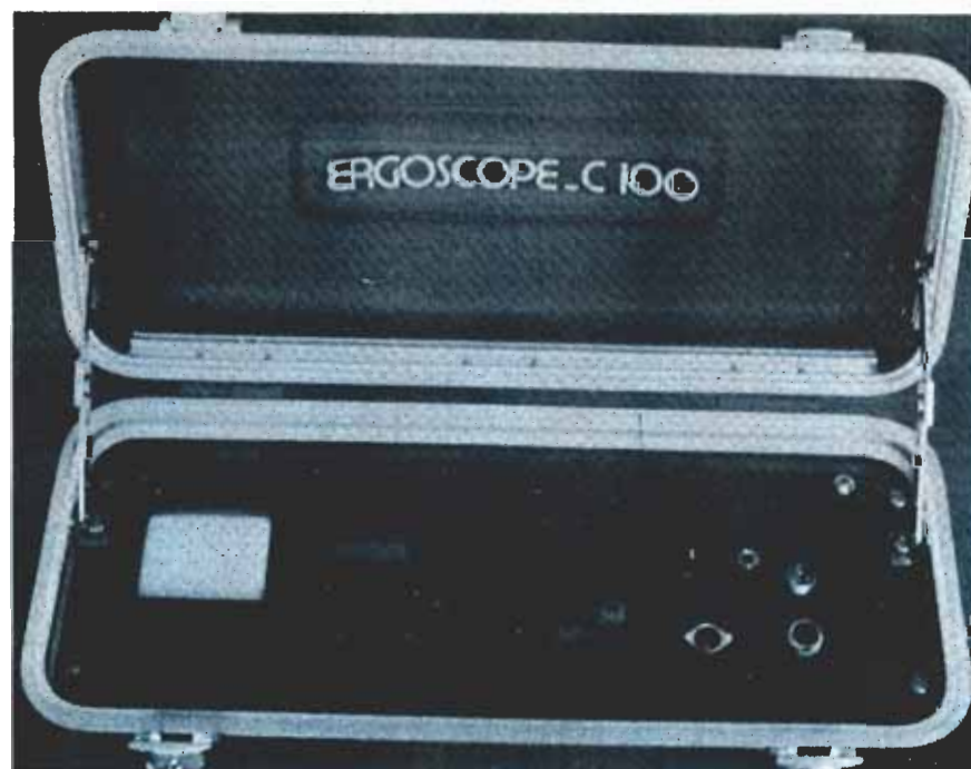
Figura 2. Aspecto del «ergoscopio - C100», un instrumento electrónico para el estudio del sistema cardiovascular.
