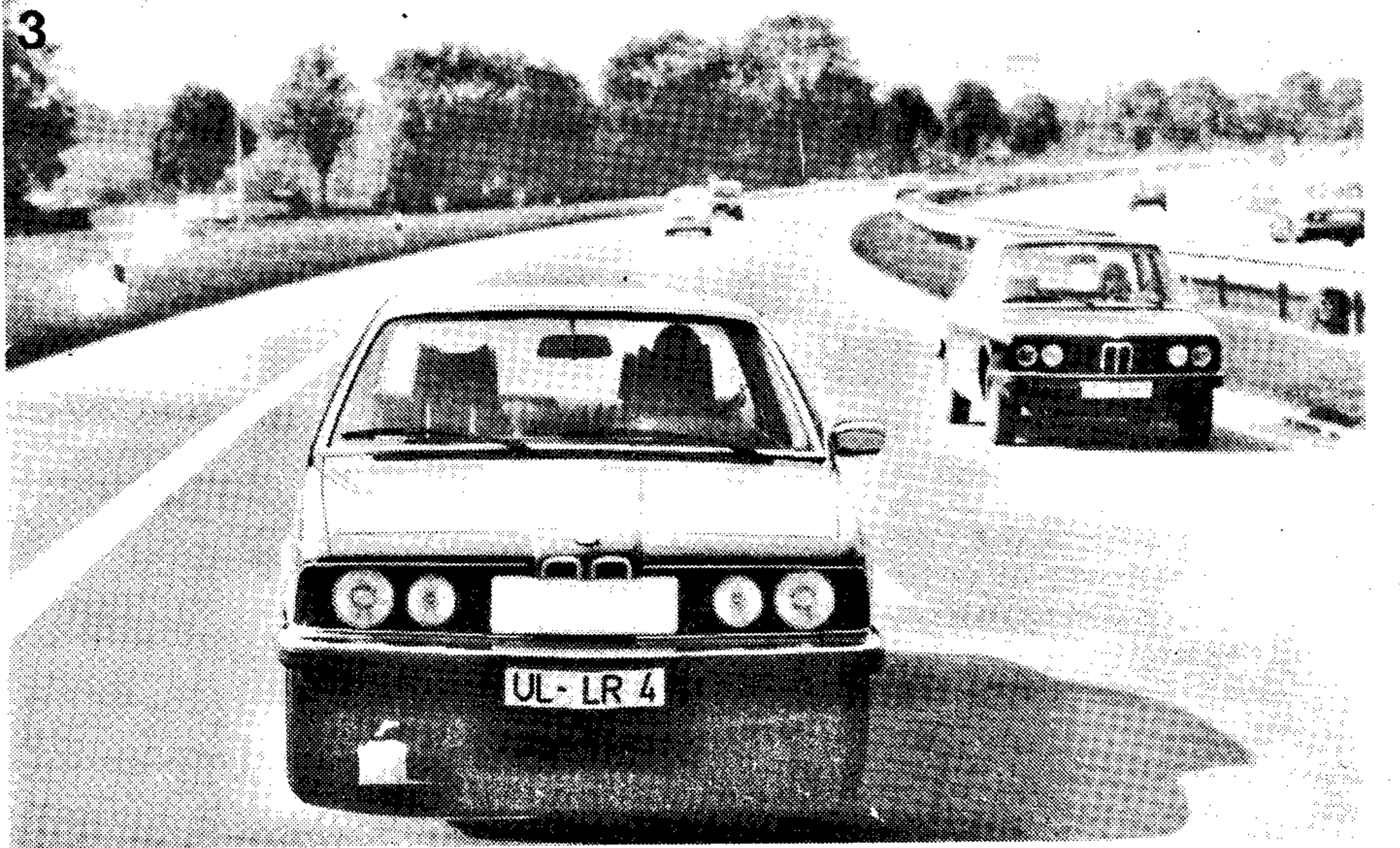
Fotografía 3. Vehículo experimental equipado con un radar para el control de distancia.
