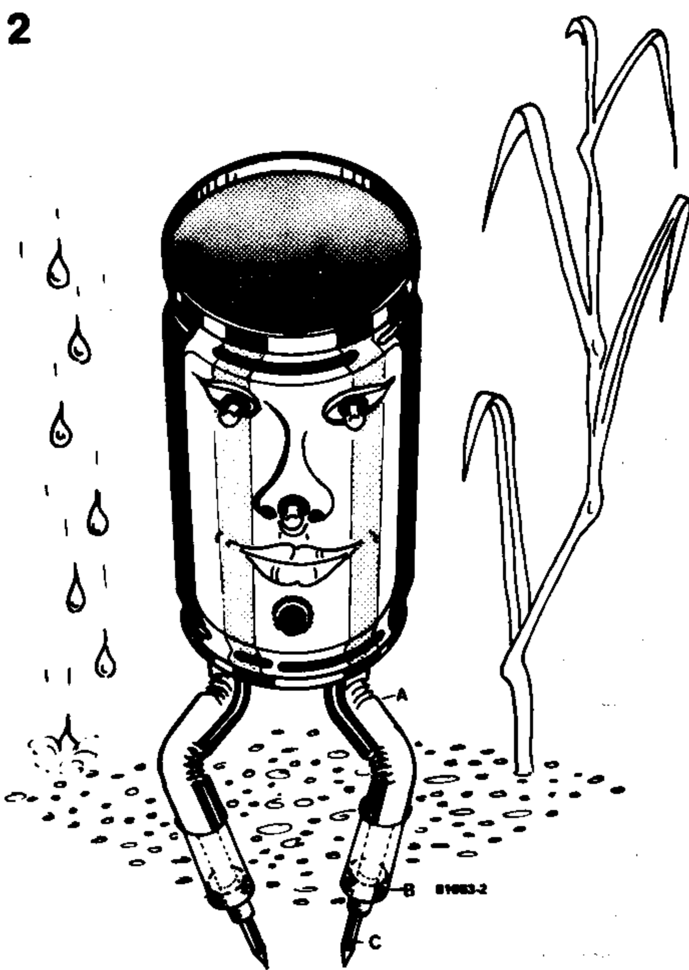
Figura 2. Aspecto exterior del medidor de humedad. Para que las medidas sean fiables, las puntas de prueba deben permanecer siempre a la misma distancia.
